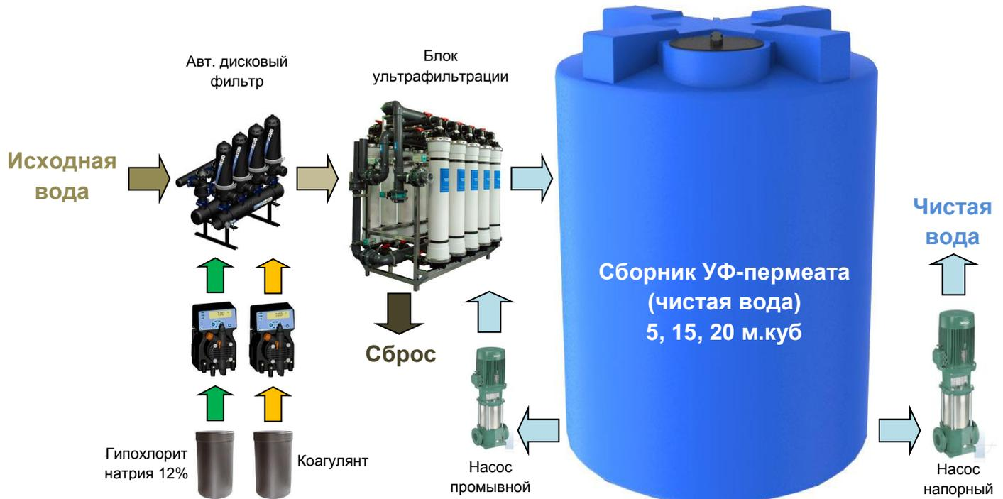
Установка ультрафильтрации представляет собой компактный функционально законченный модуль. Основное оборудование модуля, приборы КИПиА, трубная обвязка, регулирующая и запорная арматура смонтированы на металлической раме. Автоматическое управление переключением режимов работы модуля обеспечивается контроллером и комплектом автоматических клапанов. Модуль работает в периодическом режиме, основной режим — фильтрация, при этом очищенная вода помимо потребителя
